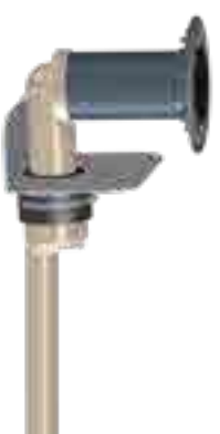
Atika slivnik HL68H/O/DN, HL68P/O/DN, HL68F/O/DN sa uljevnim elementom HL164, nastavnim elementom HL85N(H) i hvatačem lišća HL181
